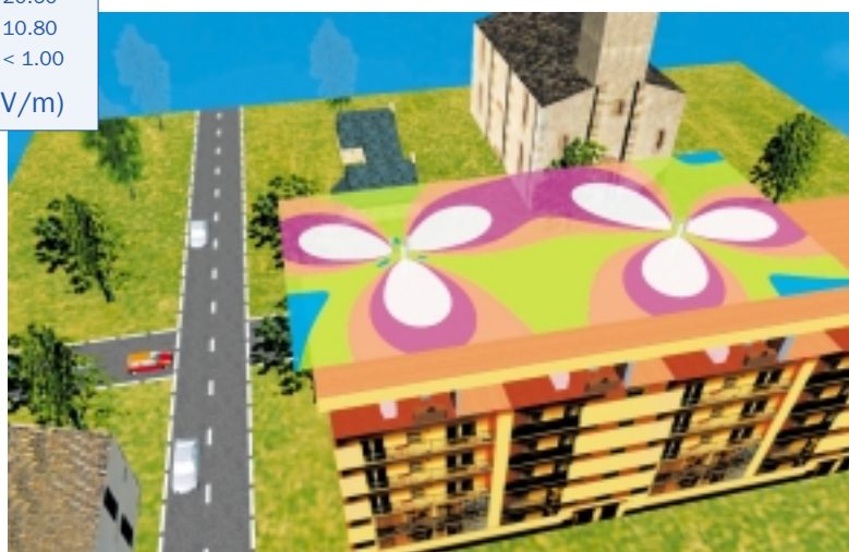
Figure 2 Sectorisation du rayonnement sur un site GSM
